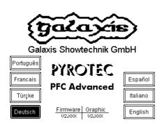
Nach dem Einschalten des Gerätes über den Schlüsselschalter "Betrieb" sehen Sie nebenstehenden Starbildschirm im Display. Hier sehen Sie auch die im Gerät installierte Softwareversion unter "Firmware" und die installierte Grafikdatei unter "Graphic". Während der Startbildschirm angezeigt wird, können Sie zwischen den angezeigten Sprachen auswählen. Nach kurzer Zeit wechselt das Gerät zum Hauptmenü.
