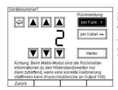
Zuerst sollten Sie den Übertragungsweg festlegen. Im Normalfall ist das 'per Funk'. Möchten Sie die Rückmeldeinformation über die Kabelschnittstelle erhalten, wählen Sie hier 'per Kabel'.
