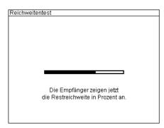
Die Funktion "Reichweitentest" benötigen Sie, wenn Sie mit Empfängern der Serie "Profi" arbeiten. Diese Empfänger arbeiten nicht bidirektional. Selbstverständlich können Sie diese Funktion aber auch mit Geräten der "Advanced"-Serie verwenden.
