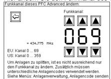
In diesem Untermenüpunkt haben Sie die Möglichkeit den für die Datenübertragung verwendeten Funkkanal, also die Frequenz, auszuwählen.
